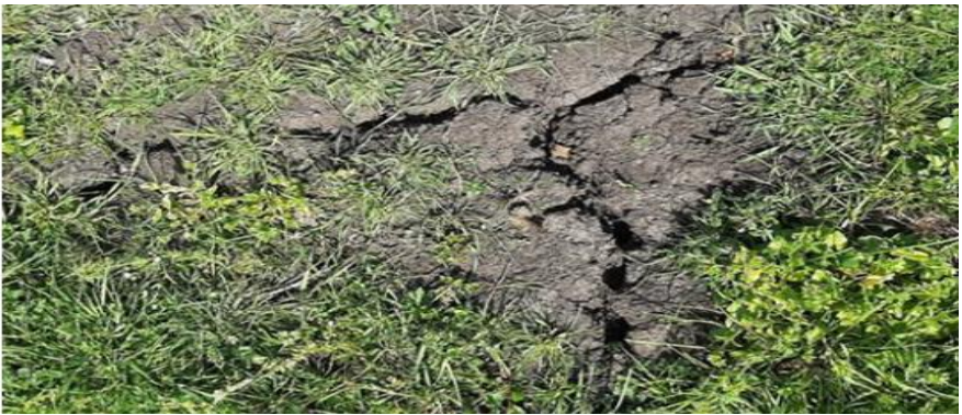
Krimpscheuren aan het oppervlak in het proefveld (boven, mei 2022). Brede en diepe scheuren in het referentieveld (onder, zomer 2022).
